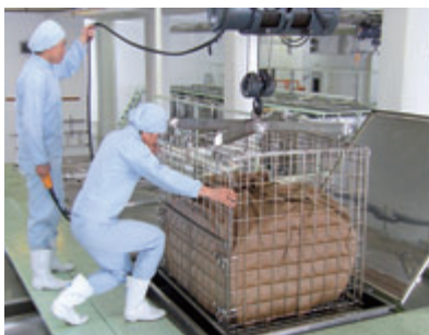
生薬浸漬抽出工程(調合した14種類の生薬を生薬袋に入れ、原酒となるみりんやアルコールに漬け込み、約2か月間規定の濃度になるまで浸漬と循環を繰り返す。)
